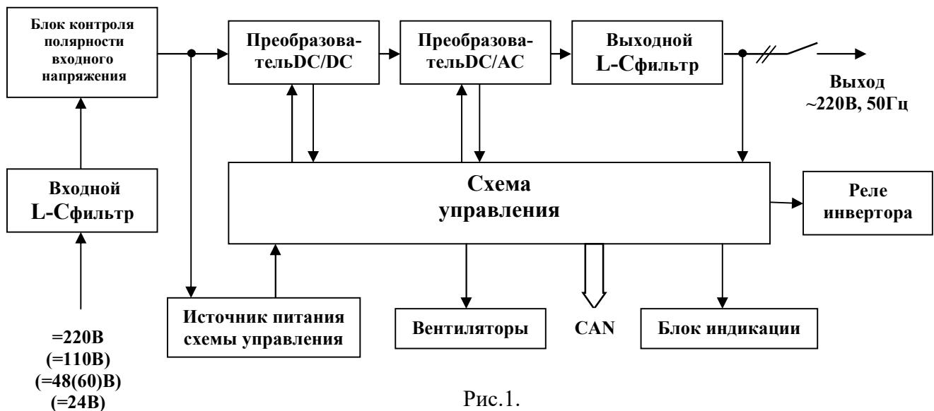
Входное постоянное напряжение через L-C фильтр, через блок контроля полярности, защищающий инвертор от неправильной полярности подключения по входу, поступает на вход преобразователя DC/DC и в источник питания схемы управления, формирующий стабилизированные напряжения питания активных элементов и обеспечивающий гальваническую развязку.
