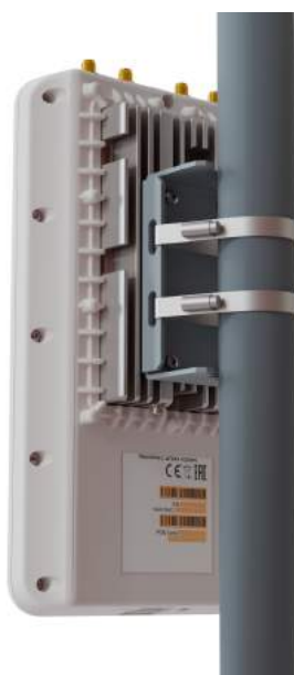
Рисунок 9 – Крепление устройства к трубостойке
