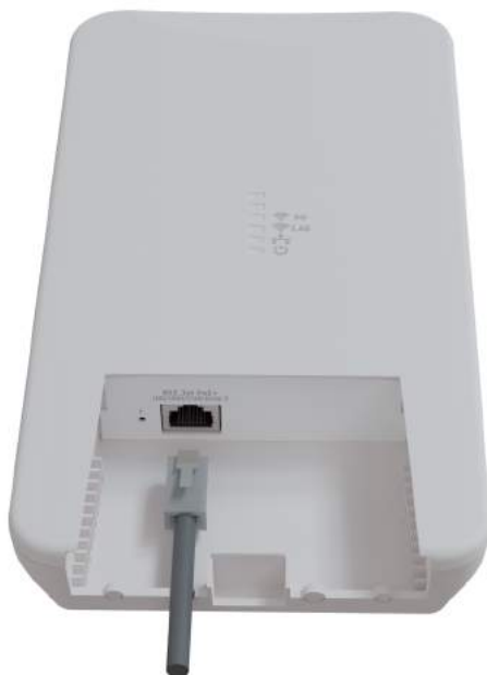
Рисунок 13 – Подключение Ethernet-кабеля к PoE-порту
