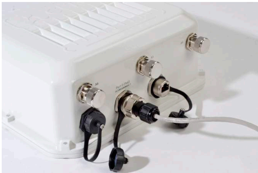
Рисунок 19 – Вид подключенного кабеля к сетевому интерфейсу устройства
