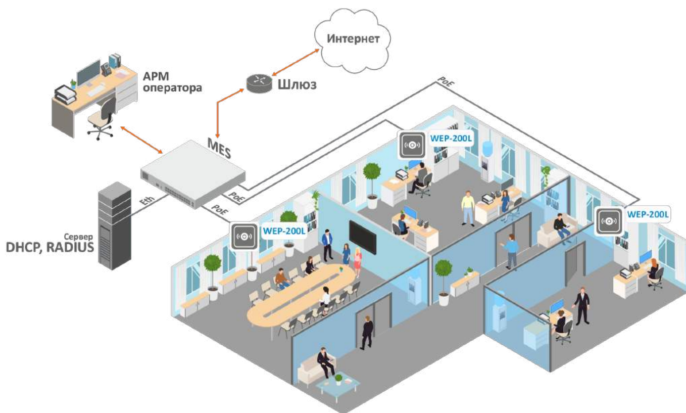
Рисунок 1 – Функциональная схема использования WEP-200L
