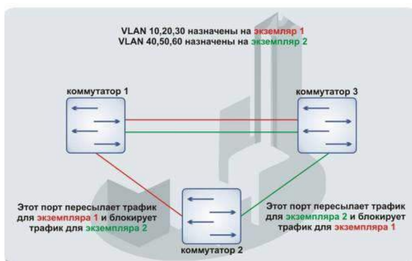
Рисунок А.1 – Настройка протокола множества связующих деревьев
