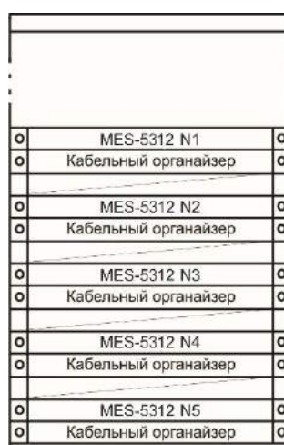
Рисунок 24 – Размещение коммутаторов MES5312 в стойке
