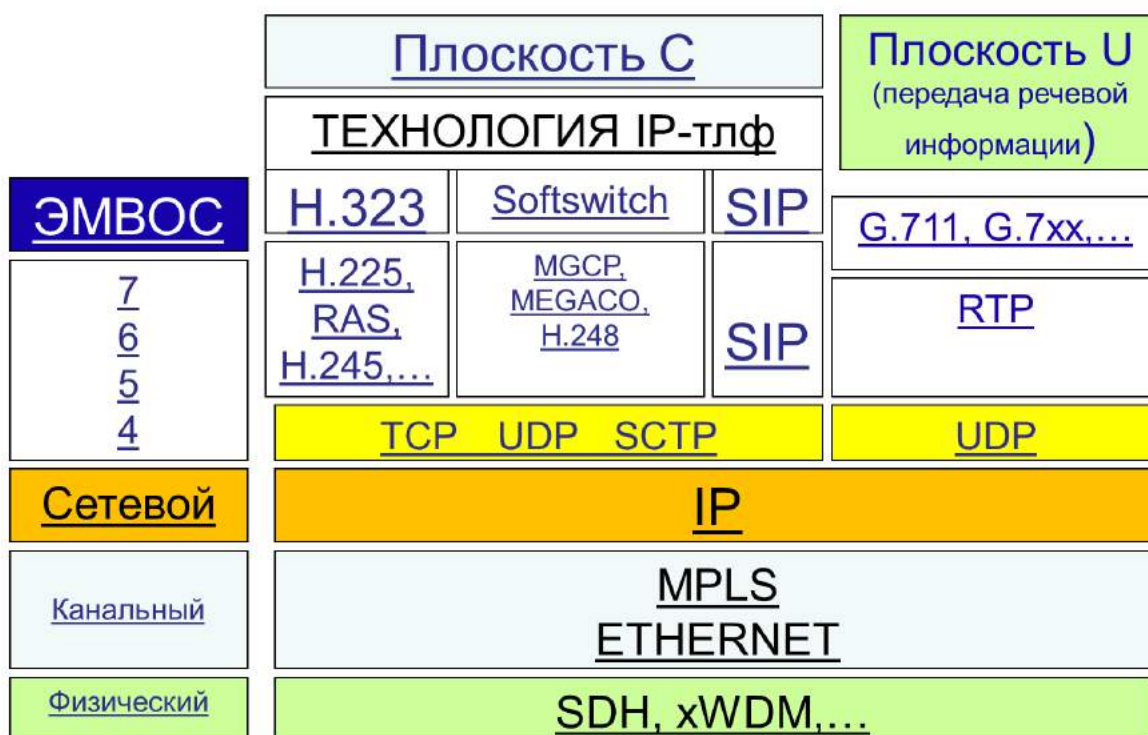
Рисунок 1.16 – Стеки протоколов по технологиям IP-телефонии
