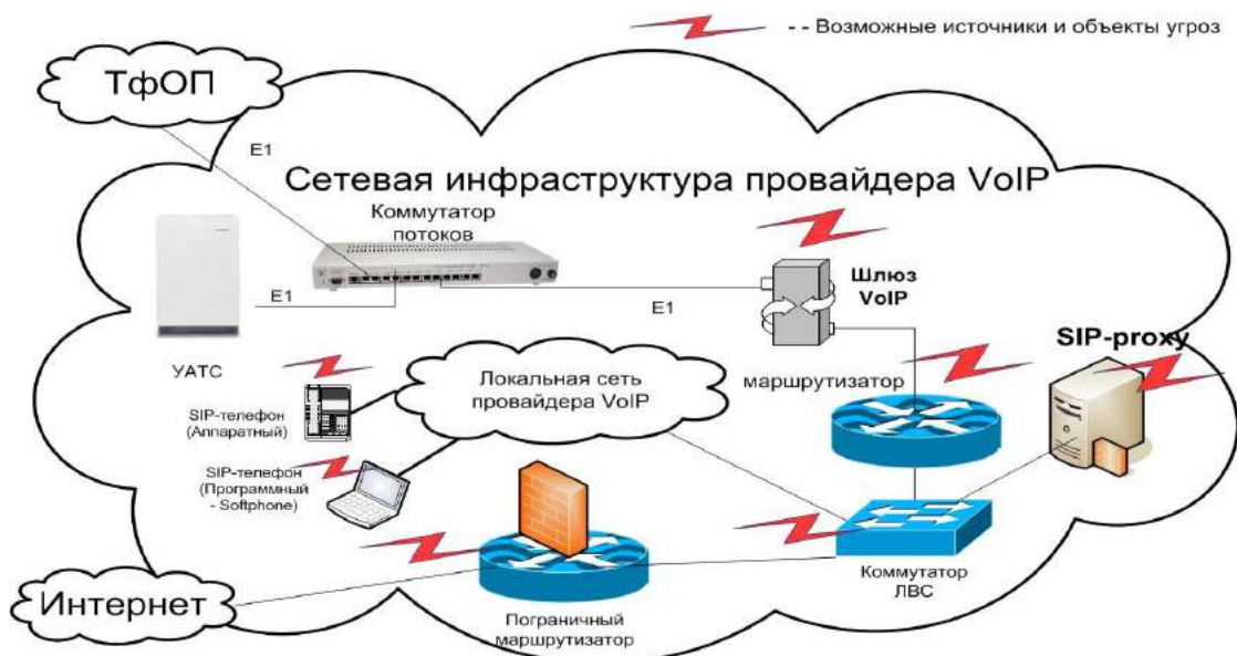
Рисунок 1.42 – Схема возможных источников и объектов угроз
