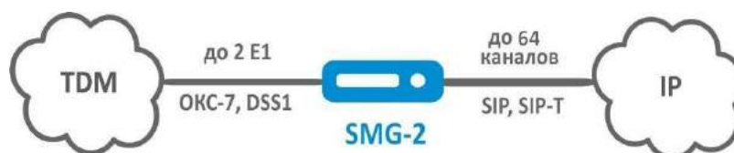
Рисунок 2 – Сопряжение сигнализаций и медиапотоків TDM- и VoIP-сетей с использованием SMG-2
