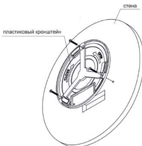
Рисунок 7 – Крепление кронштейна на стене
